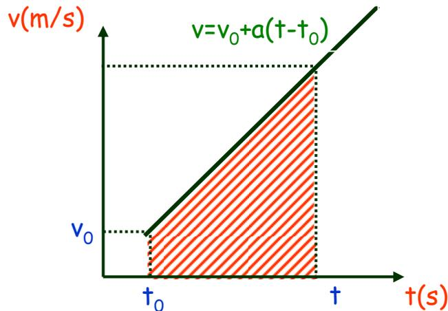
Por analogia ao resultado anterior, podemos obter o deslocamento  $\Delta x$  no MRUV através do cálculo da área sob a curva  $v \times t$
