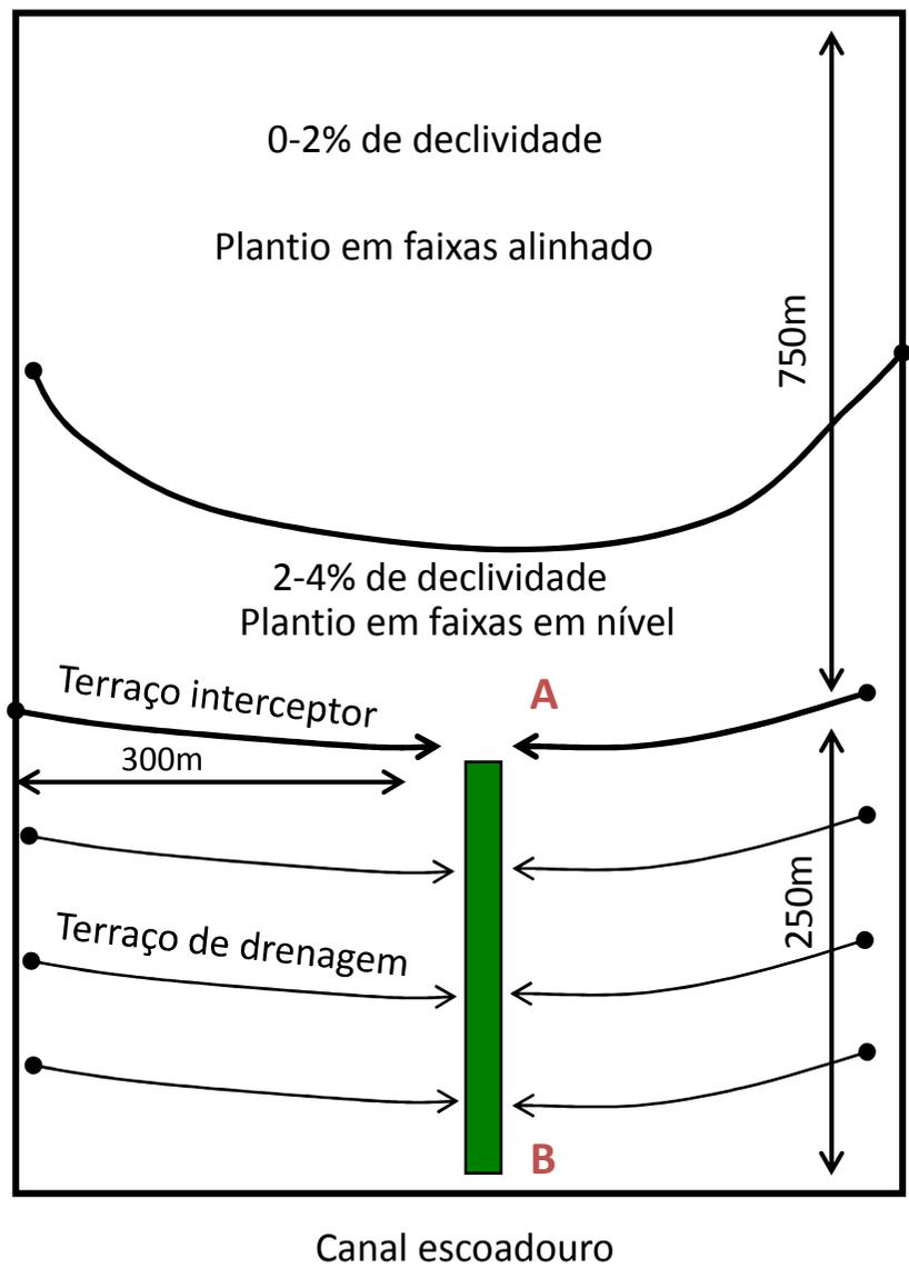
Segue o cálculo das dimensões no ponto A e B, passo a passo!
