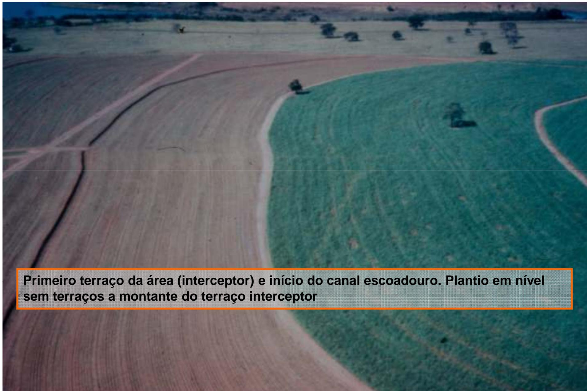
**Primeiro terraço da área (interceptor) e início do canal escoadouro. Plantio em nível sem terraços a montante do terraço interceptor**
