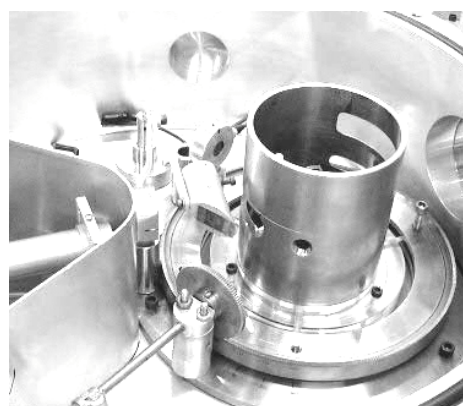
Figura 6.14. Foto do medidor de carga montado na câmara de análises RBS no LAMFI.
