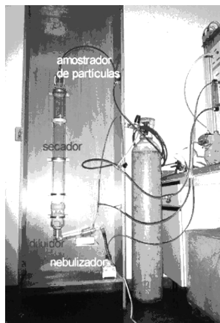
Figura 6.4. Diagrama e fotografia do dispositivo para preparo de amostras líquidas por nebulização no LAMFI. No detalhe o suporte para filtros Nuclepore.
