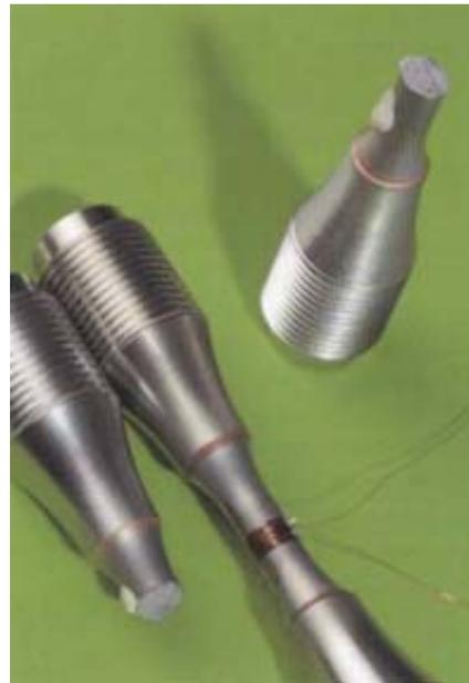
Ensaio de fadiga a quente em material resistente ao calor
