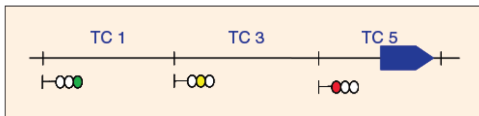
Figura 3 – Sistema de Sinalização FB (PASCOE e EICHORN, 2009)
