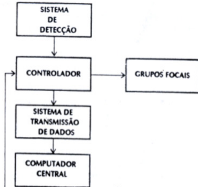
Figura 2 – Blocos básicos do sistema SCOOT (fonte: Sun Hsien Ming)
