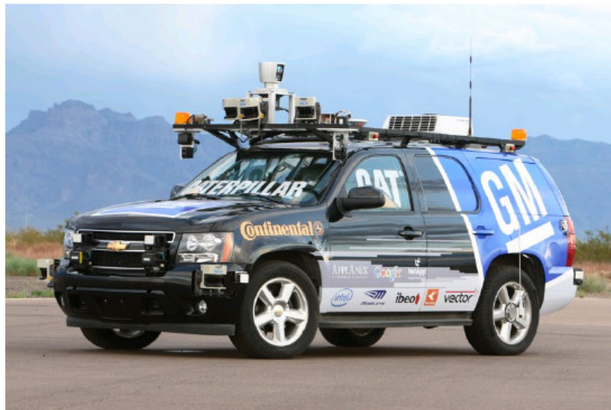
Figura 4 - Boss, robô construído no projeto Tartan Racing em um chassi Chevrolet Tahoe.
