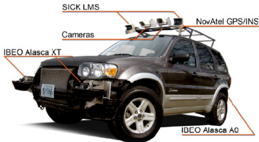
Figura 1 - Visão externa do Odin, com indicação dos sensores.
