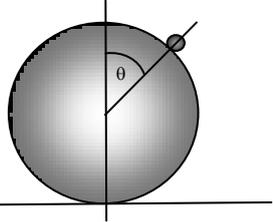
10. (Tipler Cap 9, E 99, ligeiramente modificado) Uma bola de gude, com 1 cm de raio, rola, a partir do repouso e sem escorregar, do topo de uma grande esfera de 80 cm de raio, que é fixa, como mostra a figura ao lado. Determinar o ângulo, entre a vertical que passa pelo topo da esfera, e o raio que passa pelo ponto onde a bola de gude perde contato com a superfície da esfera.
