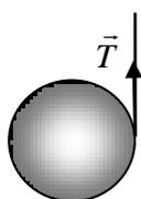
5. (Tipler Cap 9, E 70) Um cilindro homogêneo, de massa  $M$  e raio  $R$ , tem uma corda enrolada na sua superfície. A corda tem uma ponta fixa e o cilindro cai verticalmente, como mostra a figura. a) Mostrar que a aceleração do cilindro está dirigida para baixo e tem módulo  $a = 2g/3$ . b) Calcular a tensão na corda.
