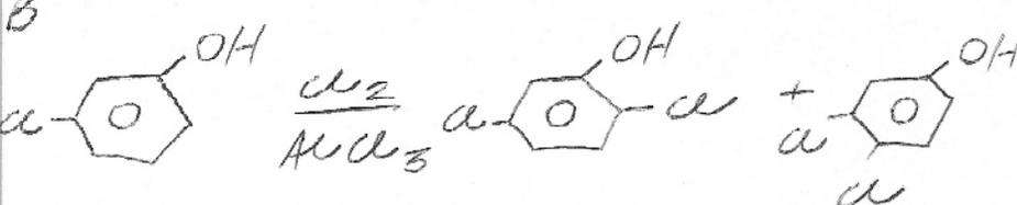
or dois substituintes são *o*, *p*-dirigentes e induzem a substituição a ocorrer nas mesmas posições do anel. É difícil a formação de benzenos 1,2,3-trinitrosubstituídos.
