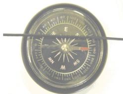
Figura 3 - Fio sem corrente elétrica
