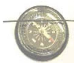
Figura 4 - Fio com corrente elétrica
