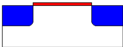
10) Fotogravação / Corrosão do óxido
