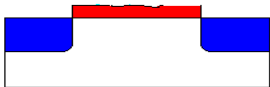
7) Deposição e Difusão de dopantes: formação de fonte e dreno
