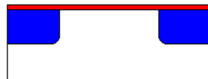
9) Oxidação térmica: óxido de porta
