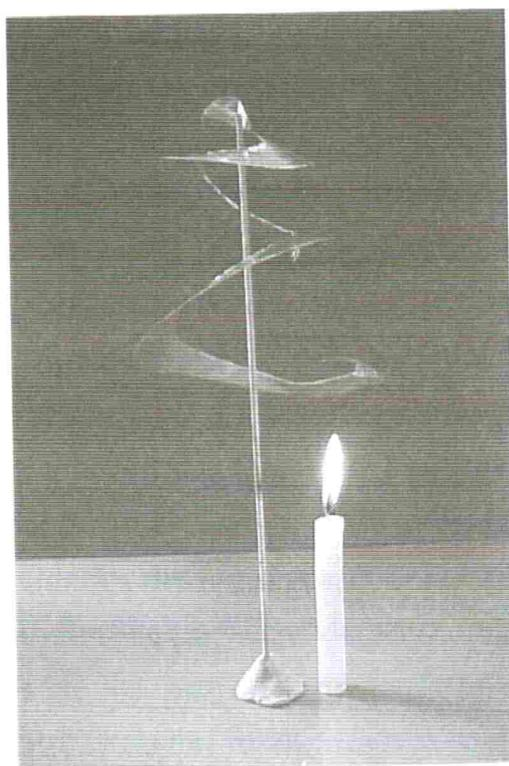
Figura 3: Arranjo experimental utilizado para a demonstração de convecção nos gases.
