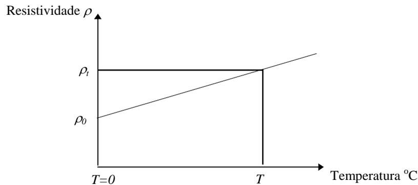
Figura 2.3 - Variação da resistividade com a temperatura
