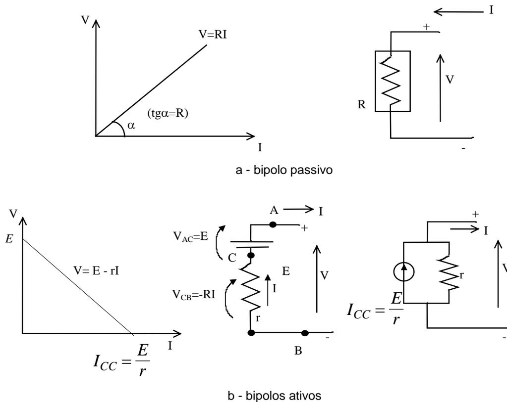
Figura 2.4 - Características externas de bipolos elétricos
