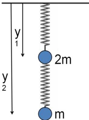
10. Duas massas,  $2\mathbf{m}$  e  $\mathbf{m}$ , conectadas por molas de constante  $\mathbf{k}$ , estão suspensas verticalmente de um ponto fixo como mostra a figura. Considere o comprimento natural das molas  $\mathbf{l}_1$  e  $\mathbf{l}_2$  e as coordenadas das massas  $\mathbf{y}_1$  e  $\mathbf{y}_2$  respectivamente.
