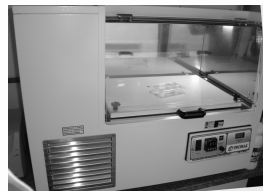
Agitador Orbital Termostatzado Experimento realizado sob agitação moderada 25 a 50 rpm a 37°C
