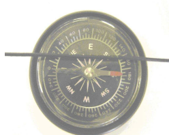
Figura 3 - Fio sem corrente elétrica
